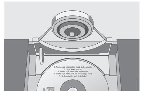
Drücken Sie die LOAD-Taste rechts auf dem Bedienfeld, um den CD-Halter anzuheben.
